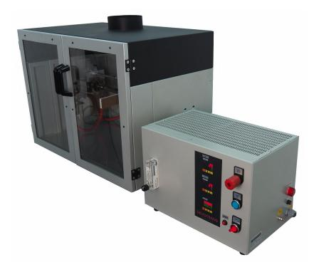
USED TO TEST FIREPROOFNESS OF PLASTERBOARDS
